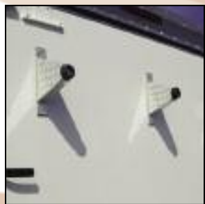
Ramp Door Pedestals
